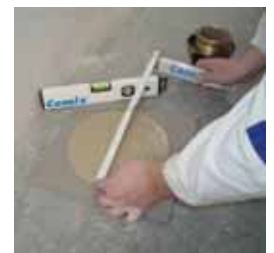
Rozlité materiálu ze zkušebního kužele
