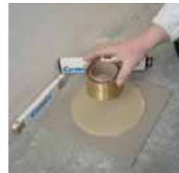
Rozlité materiálu ze zkušebního kužele
